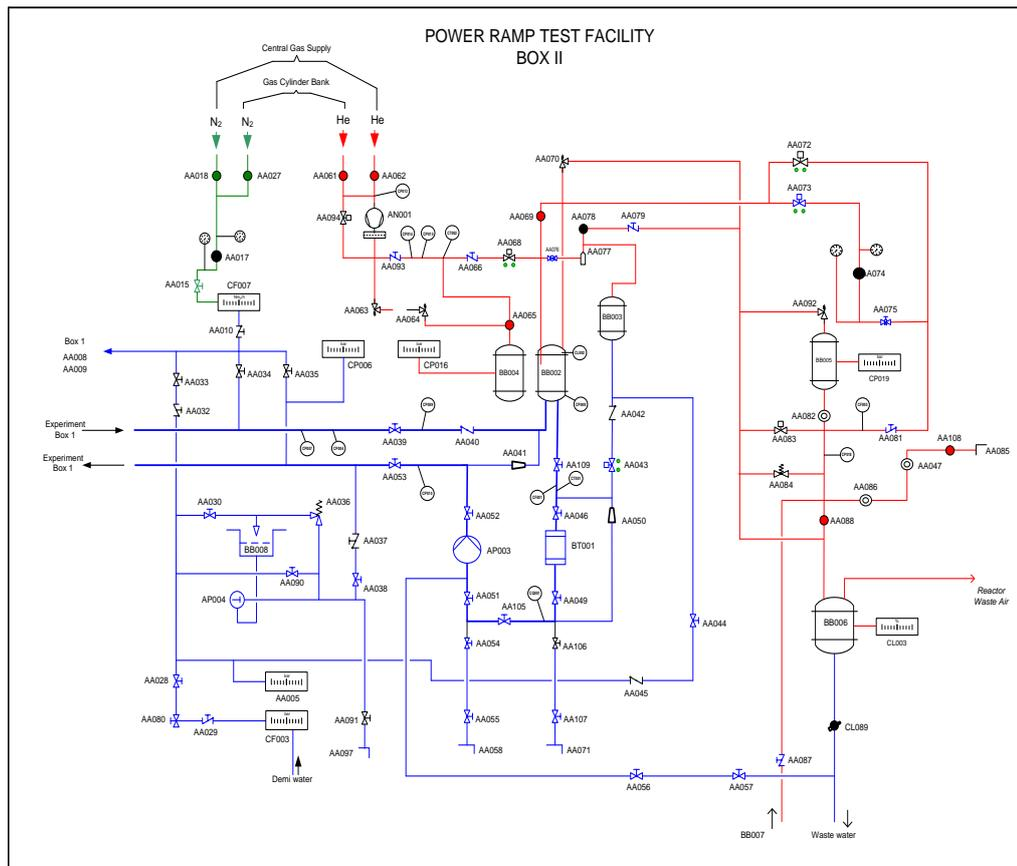
Gambar 2. Diagram alir sistem PRTF box 2
