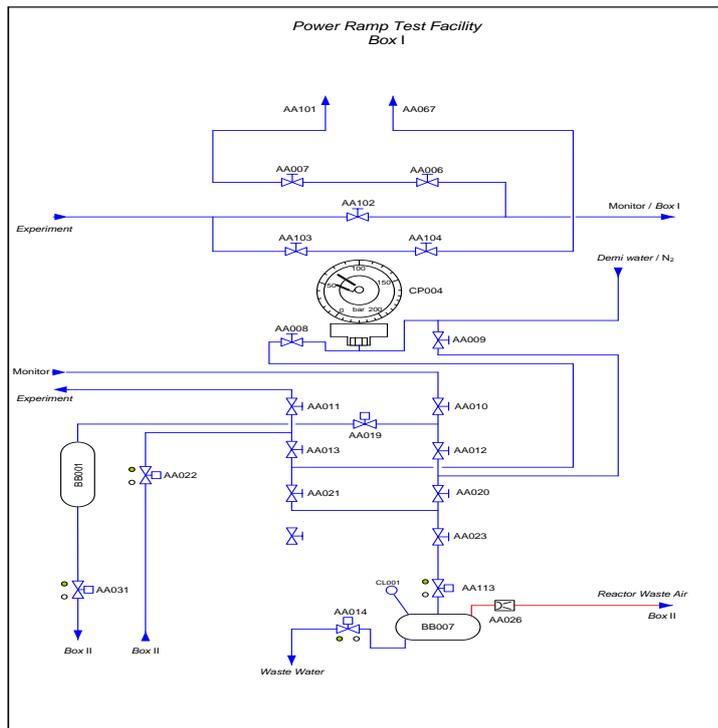
Gambar 3. Diagram alir Sistem PRTF box 1.
