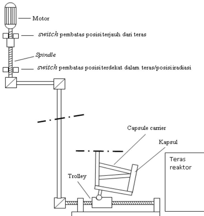
**Gambar 1.** Skema sistem penggerak kapsul
